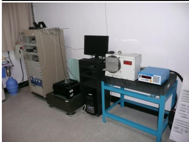
比較式低頻加速規、傾斜計校正系統
